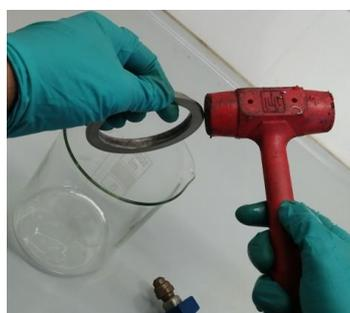
4.2.5 Procedere al **lavaggio** di tutte le parti non sigillate del componente utilizzando il prodotto "**Etere di petrolio**" o equivalente (esempio "Desodo 50"). Caratteristica importante è che il prodotto utilizzato sia un solvente e non un detergente. Nel caso di componenti approvvigionati "oliati" o con trattamenti protettivi particolari usare, se possibile, in sostituzione del solvente, acqua
