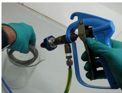
Al termine del lavaggio spostare il componente su una superficie accuratamente pulita e trasferire solvente ed impurezze raccolte in un contenitore di politene, precedentemente pulito e opportunamente identificato, lavando bene la vaschetta per raccogliere completamente i residui.
